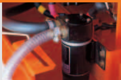
Bomba eléctrica de suministro de combustible
